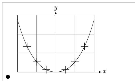
Nesta figura, cada metade simétrica da “parábola”  $y = \cosh x - 1$  é aproximada por uma curva quadrática de Bézier. A metade do lado direito da curva termina no ponto  $(2, 2.7622)$ , com a inclinação com valor  $m = 3.6269$ . Usando de novo a equação (5.1), podemos calcular os pontos intermédios de controlo:  $(1.2384, 0)$  e  $(-1.2384, 0)$ . As cruzez indicam pontos da “parábola” *real*. O erro quase que passa despercebido, sendo menor do que um por cento.
