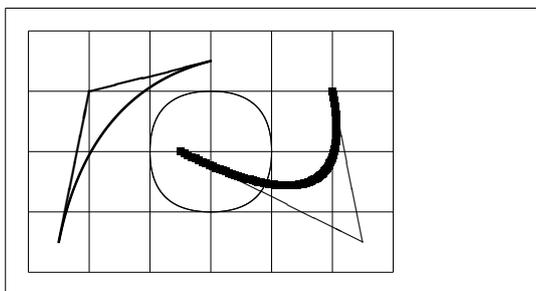
Como este exemplo ilustra, dividir um círculo em 4 curvas quadráticas de Bézier não é satisfatório. Pelo menos são precisas 8. A figura mostra o efeito do comando `\linethickness` em linhas horizontais ou verticais, e o efeito dos comandos `\thinlines` e `\thicklines` em segmentos de recta oblíquos. Também mostra que ambos os tipos de comando afectam as curvas quadráticas de Bézier, cada comando substituindo todos os anteriores.
